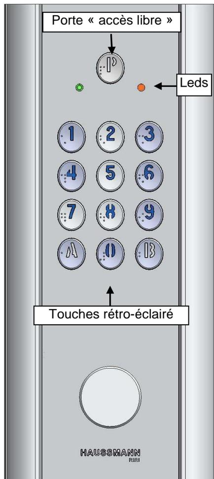
Les 13 touches sont rétro éclairées, un bip accompagne chaque appui de touche. Lors de l'ouverture de la porte un bip est émit et la led verte s'allume : le clavier est compatible « loi handicapée ». Le clavier HAUSSMANN RIRI est munie d'un second relais vous permettant de piloter une seconde porte.
