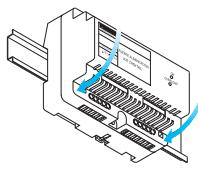
Desmontaje del carril DIN
