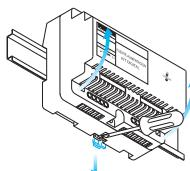
Montaje mediante tornillos
