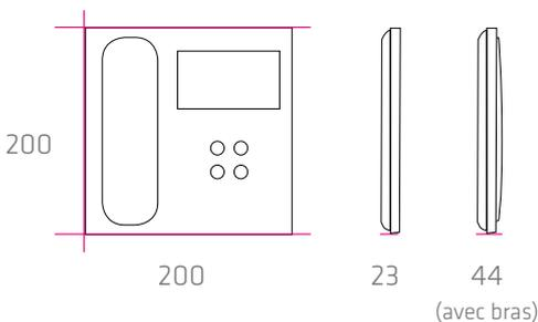
Dimensions : (largeur) x (hauteur) x (profondeur) mm.
