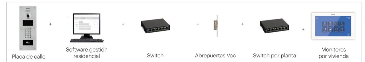
El sistema MEET de FERMAX es una tecnología 100% IP basada en una infraestructura Punto a Punto, altamente eficiente, flexible y con gran adaptabilidad.
