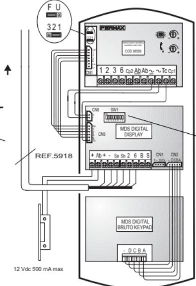
Microinterrupteurs de configuration
