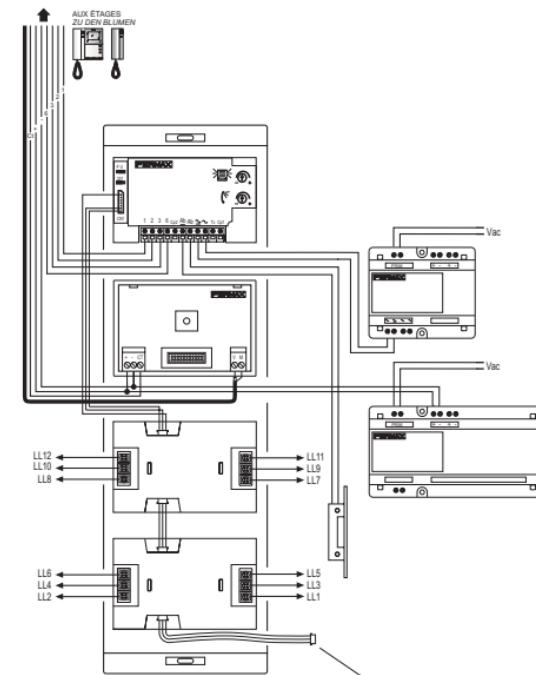
Connexion aux modules poussoirs suivants (le cas échéant)
