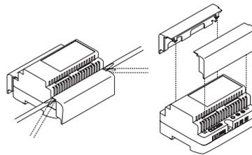
Montaje de las tapas DIN de protección.
