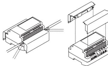
Montaje de las tapas DIN de protección.
