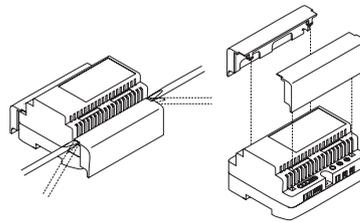
Montaje de las tapas DIN de protección.
