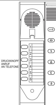
Telefon Art.-Nr. 8084 für Installationen mit Innenverbindung und Verbindung zur Frontplatte. Es wird der Umschalter Art.-Nr. 9017 verwendet.
