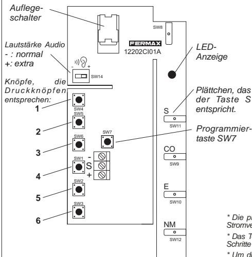
**1. Deckplatte des Telefons abnehmen, Auflegeschalter gedrückt halten und die Programmertaste SW7 drücken.**
