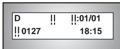
Si la llamada proviene de un teléfono de otro bloque, ésto vendrá indicado en el display.
