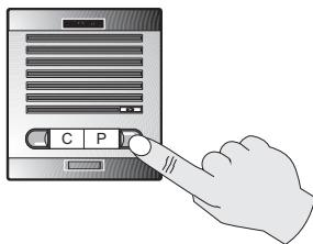
**1.** Der Notruf wird durch die Taste "NOTRUF" an der Türstation ausgelöst. Die Portierzentrale gibt einige Signaltöne aus und zeigt an, dass ein Anruf eingegangen ist.
