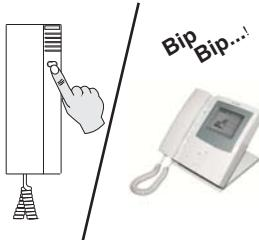
1. Ein Bewohner ruft den Portier an. Die Portierzentrale gibt einige Signaltöne aus und zeigt an, dass ein Anruf eingegangen ist. Außerdem blinkt die LED an der Portierzentrale auf und das entsprechende Symbol im **Bereich 2** wird eingeblendet.
