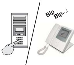
1. Die Portierzentrale gibt einige Signaltöne aus, die LED blinkt und das Symbol wird in **Zone 2** eingeblendet, wodurch angezeigt wird, dass Anrufe gespeichert wurden, die zu beantworten sind.
