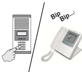
1. Anruf von einer Türstation in eine Wohnung. Die Portierzentrale gibt einige Signaltöne aus, die LED blinkt und das entsprechende Symbol wird angezeigt.
