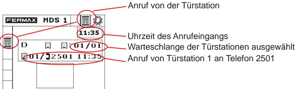
Zur Herstellung einer Sprechverbindung mit der Türstation drücken Sie:
