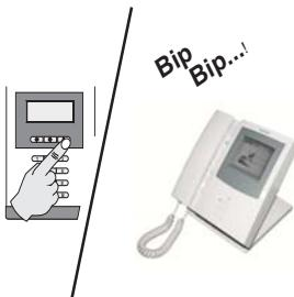
1. Der Besucher ruft von der Türstation durch Drücken der Taste "GLOCKE" an. Dabei gibt die Portierzentrale "Signaltöne" aus, die LED beginnt zu blinken und in **Zone 2** wird das entsprechende Symbol eingeblendet.
