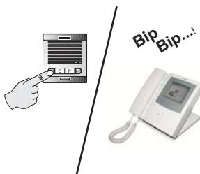
1. Es wird von einer Türstation durch Drücken der Taste "PORTIER" angerufen. Die Portierzentrale gibt einige Signaltöne aus, die LED und das Symbol beginnen zu blinken.
