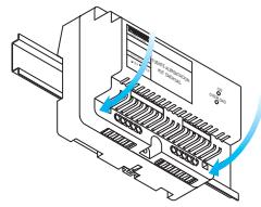
Desmontaje del carril DIN
