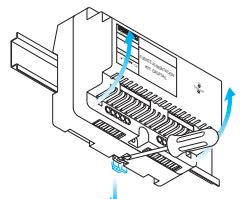
Montaje mediante tornillos
