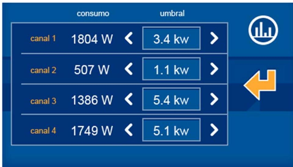
Como se comenta, a cada canal se le puede establecer un límite superior, por debajo del cual se deben mantener los valores de consumo medidos. En caso de superar dicho rango, la instalación desencadenara una serie de acciones para corregir el exceso de demanda según los parámetros que se le hayan configurado. Los límites por canal se fijan pulsando las flechas laterales a ambos lados del valor establecido. A la izquierda para reducir el límite y a la derecha para aumentarlo.
