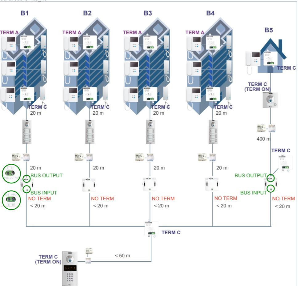
Distancias para cable 2x1mm<sup>2</sup> - Cable distances 2x1mm<sup>2</sup>
