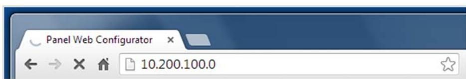
Introducir la dirección IP del módulo de vídeo / placa HI-LINE en la barra de direcciones del navegador
