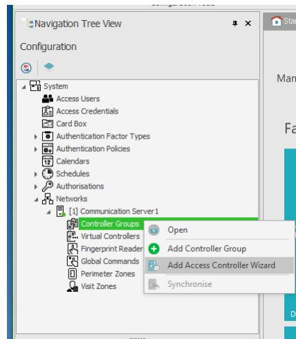
Der Zweck der Low-Level-Konfiguration des Controllers besteht darin, die Eigenschaften des Controllers zu definieren. Es gibt mehrere Low-Level-Konfigurationen, aber die wichtigste ist die IP-Adresse und der Kommunikationsschlüssel, der verwendet wird, um die Kommunikation mit dem Controller im Ethernet-Netzwerk zu verschlüsseln. Dieses Handbuch verwendet einen Zugriffscontroller mit Firmware 1.7.2 oder höher und wir werden dies von AC-MAX ST tun.
