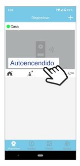
Para probar el desvío de llamadas, el usuario tiene que realizar un autoencendido y ver que se conecta con la placa de calle, (siempre y cuando no esté en uso y lo permita).
