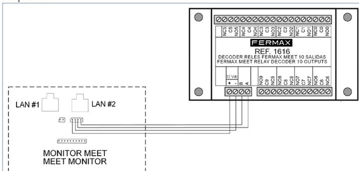
Para la activación de los dispositivos a controlar, utilizar las salidas de relé 1 a 8, correspondiendo con las activaciones R1 a R8 de la pantalla de control del monitor. Las salidas de relé 9 y 10 no se utilizan.
