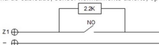
Esquema de cableado, sensor normalmente abierto, opción 3C.
