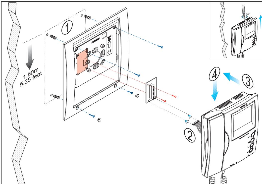
**E** El marco embellecedor para el monitor LOFT es de instalación mural. Dispone de múltiples puntos de anclaje, para que el instalador pueda escoger los más apropiados (recomendamos los de los 4 extremos). Disponible con o sin conector de instalación del monitor.
