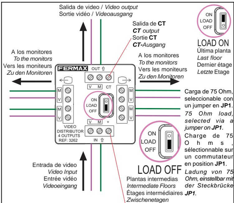
+ Entrada de alimentación del distribuidor de video (10-18 Vdc) / Video Distributor Power Input (10-18 Vdc) / Entrée d'alimentation du répartiteur vidéo (10-18 Vcc) / Stromeingang des Videoverteilers (10-18 VDC).
