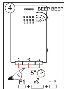
1. Um diese Funktion zu **aktivieren**, müssen die drei folgenden Tasten 5" lang gleichzeitig gedrückt werden, bis ein Piepton ertönt: Taste-F1, Taste  $\text{🔔}$  und Taste  $\text{→}$ .
