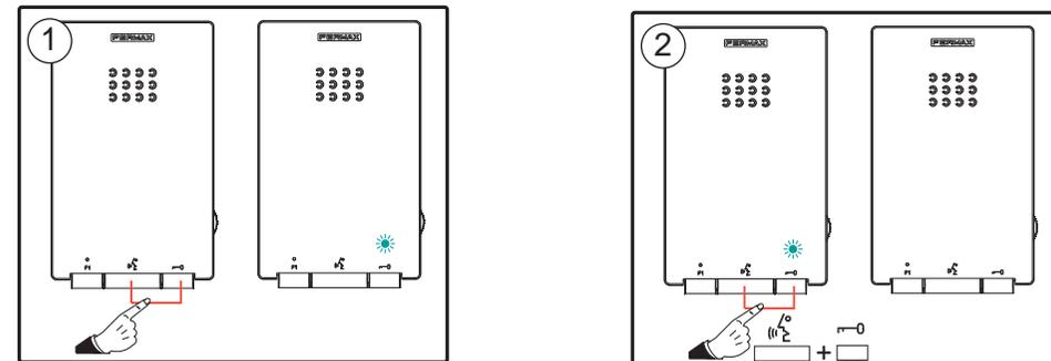
1. Um diese Funktion zu **einuschalten**, müssen die Taste  $\text{🔔}$ , sowie die Taste  $\text{→}$  gleichzeitig gedrückt werden, bis die grüne LED blinkt. Ist die Funktion aktiviert, wird beim Klingeln die automatische Türöffnung ausgelöst.
