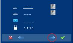
3º. Para seleccionar programación desde placa, se debe seleccionar la placa de la línea VDS # mediante la flecha derecha.
