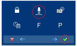
1º. Una vez el instalador accede a la pantalla menú de configuración, seleccionar la opción modo de conversación, mediante los cursores (línea blanca abajo del icono) y pulsar ✓. Se visualiza la pantalla mostrada a continuación.
