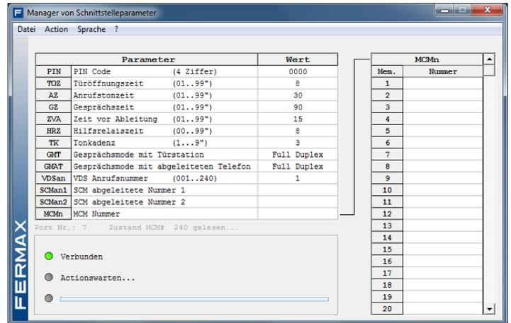
Anhand eines Beispiels soll ein aus der Schnittstelle eingelesener Tabellenwert geändert werden. Dazu die Zeile "Tonkadenz" markieren, die in der Abbildung gelb unterlegt ist. Um diesen Parameterwert zu ändern, mit der Maus auf Wert-Spalte doppelklicken.
