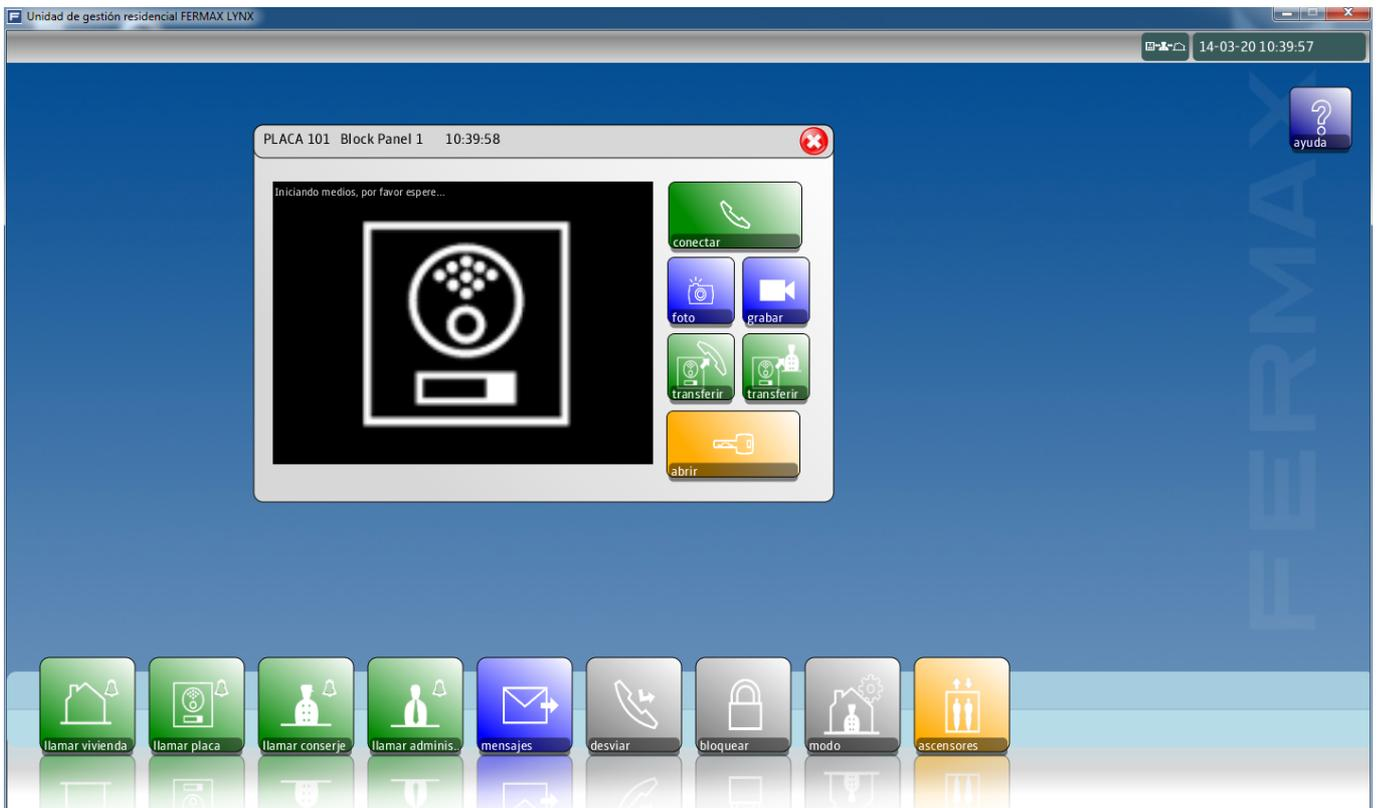
Una vez encontrada la placa se muestra la imagen de la cámara de dicha placa. Ahora el Conserje ya puede pulsar "Conectar" para ponerse en comunicación con la placa.
