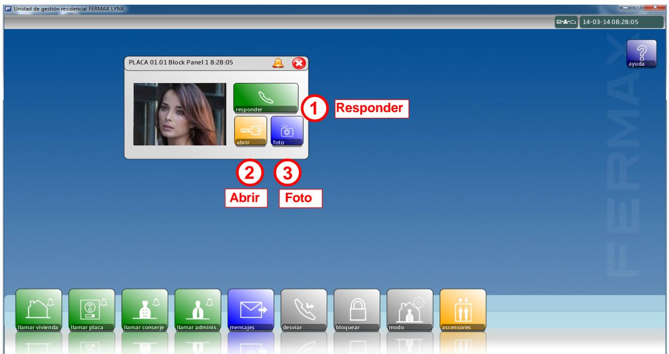
1. Responder. Conexión de audio. Abre el canal de audio en ambos sentidos entre placa y conserje. El nivel de recepción de audio se puede ajustar.
