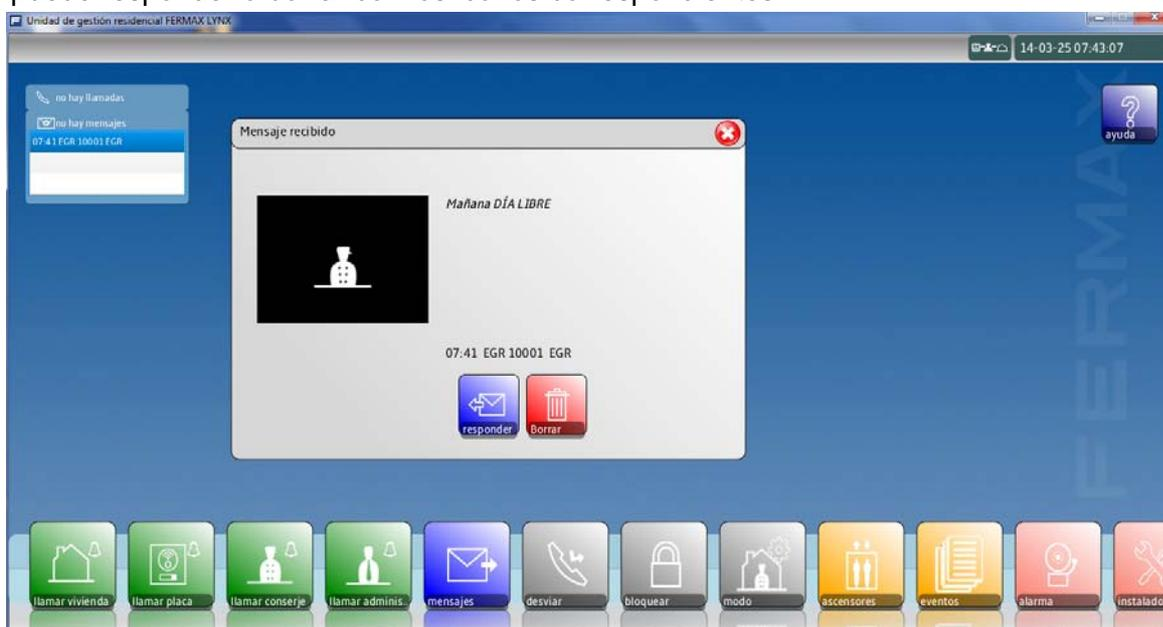
**Nota:** Las opciones relacionadas con mensajes que se van a explicar a continuación (**inquilino, servicios y teléfono**), requieren que esté instalado el Modem GSM. Para más detalles sobre el Modem GSM ver punto **4.3 MANTENIMIENTO**.
