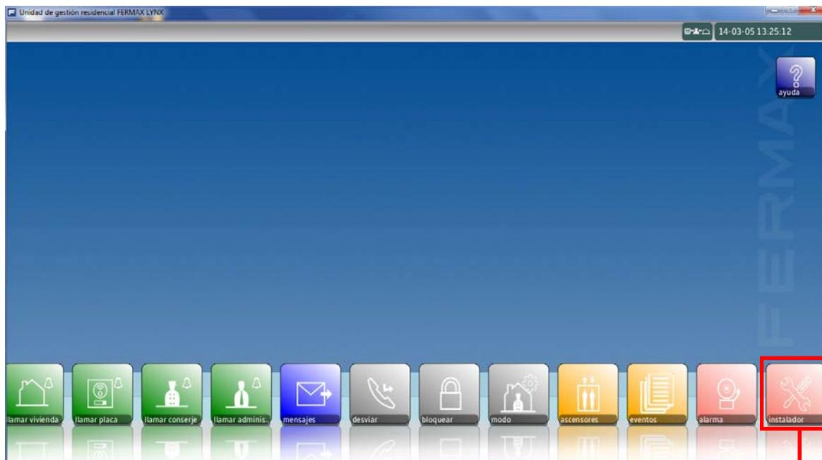
Seleccionando **instalador**, accedemos a las diferentes pantallas para realizar la puesta en marcha de la instalación.
