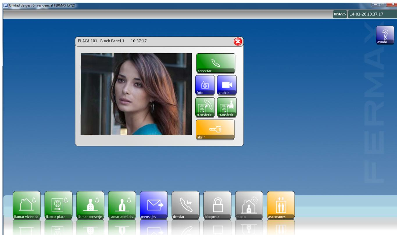
Al pulsar "Conectar" se abre el canal de audio en ambos sentidos entre placa y conserje. El nivel de recepción de audio se puede ajustar.
