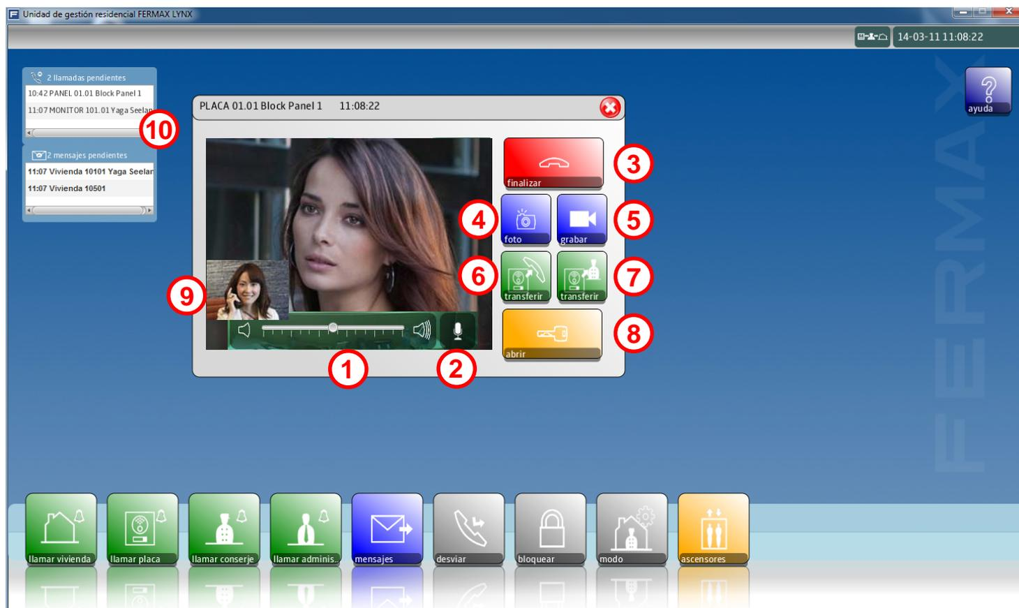
1. Ajuste de audio. El nivel de recepción de audio se puede ajustar.
