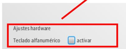
Si durante el proceso de la instalación, la opción Teclado alfanumérico se ha seleccionado se visualiza dicho teclado en pantalla. Esto es útil si la pantalla de su PC es táctil.
