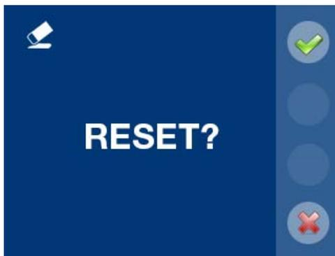
**Nota:** El led rojo parpadeando rápido indica que el monitor está sin programar. Como el reset borra la dirección del monitor programada, cuando el led esté parpadeando indicará que el reset ya ha finalizado.
