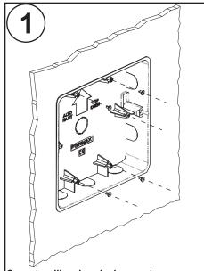
Sacar tornillos de caja de empotrar Remove the screws from the flush mounted box Retirer les vis du boîtier à encastrer Schrauben des Unterputzkastens entfernen
