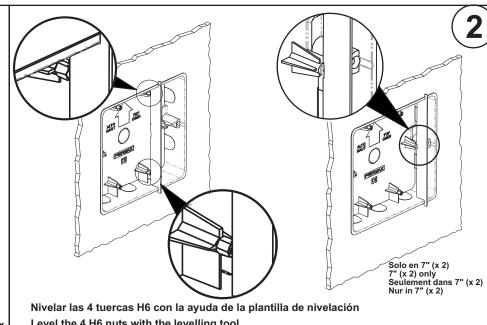
Nivelar las 4 tuercas H6 con la ayuda de la plantilla de nivelación Level the 4 H6 nuts with the levelling tool Niveler les 4 écrous H6 à l'aide du gabarit de nivellement Muttern mit 4 Hilfe der Vorlage zur Nivellierung ausgleichen
