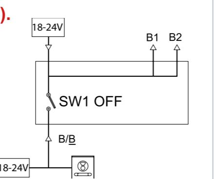
**a). Modo Alimentación sólo troncales:** en este caso la alimentación llega a cada una de las troncales. Las troncales de salida son automáticamente alimentadas por la fuente y filtradas por el regenerador. Para emplear este modo de funcionamiento se debe realizar la siguiente configuración:
